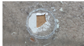
Prova di Trazione a rottura su ceramica. Valore medio 2,5 N/mm 2
